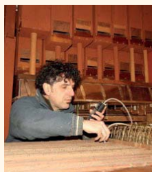
Ettore Bastici mentre controlla la pressione in un somiere
