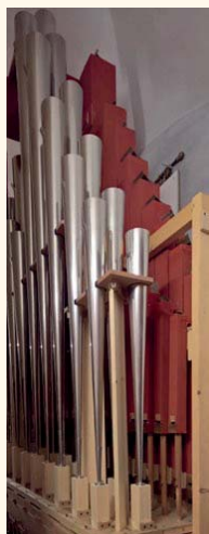
Sezione del pedale: la nuova Bombarda 16' in metallo; dietro il Basso 8' e il Contrabbasso 16'.
