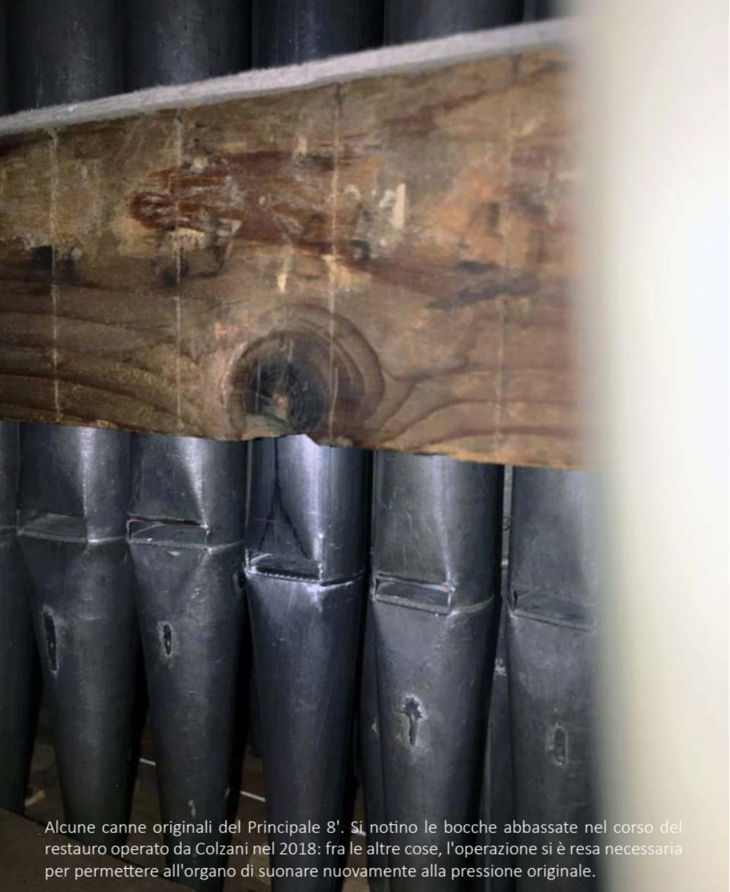
Alcune canne originali del Principale 8'. Si notino le bocche abbassate nel corso del restauro operato da Colzani nel 2018: fra le altre cose, l'operazione si è resa necessaria per permettere all'organo di suonare nuovamente alla pressione originale.
